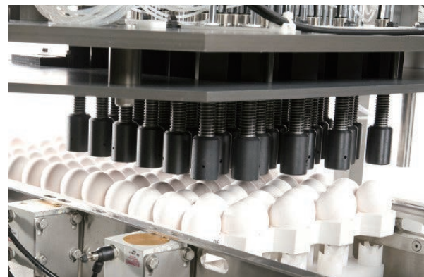
イノボジェクト(卵内接種機) Inovoject (Egg injection machine)
